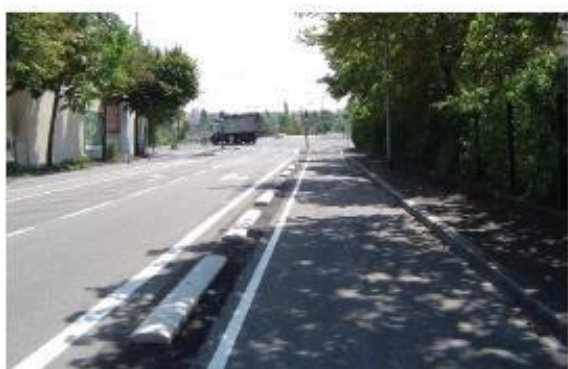
Piste cyclable bidirectionnelle sur chaussée + bordures séparatives franchissables
